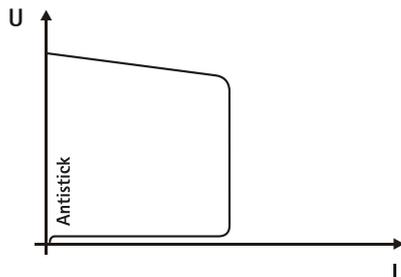
**Устройство Antistick предотвращает прокаливание электрода.**
