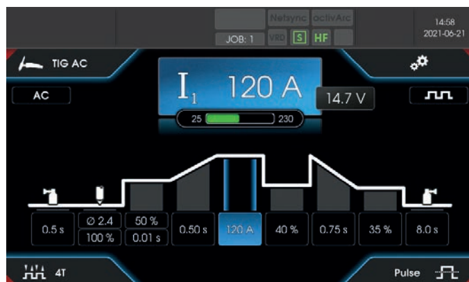
Grafisk tilpasning af alle parametre i forløbsdiagrammet
