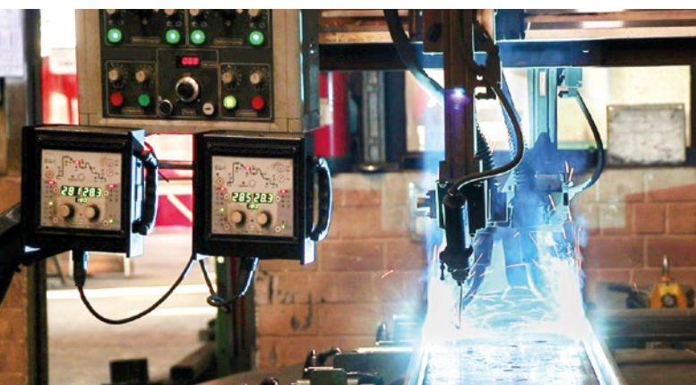
Automatisierte Fertigung des Grundträgers mit zwei EWM-AMT-Brennern parallel. Durch forceArc puls wird der Verzug vermindert, die Schweißgeschwindigkeit erhöht und die Prozesssicherheit gesteigert.
