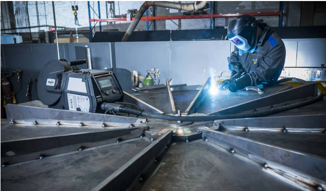
POLLRICH konstruiert und fertigt auch die Werkzeuge für ihre eigene Produktion. Hier wird eine Planscheibe für eine Drückvorrichtung mit Streben versteift.
