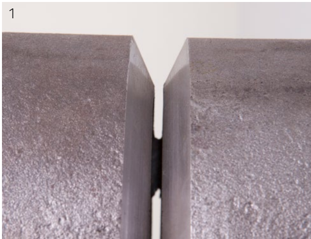
1 Nahtvorbereitung einer Wurzelschweißung am Rohr, 60° Öffnungswinkel mit 3 mm Luftspalt
