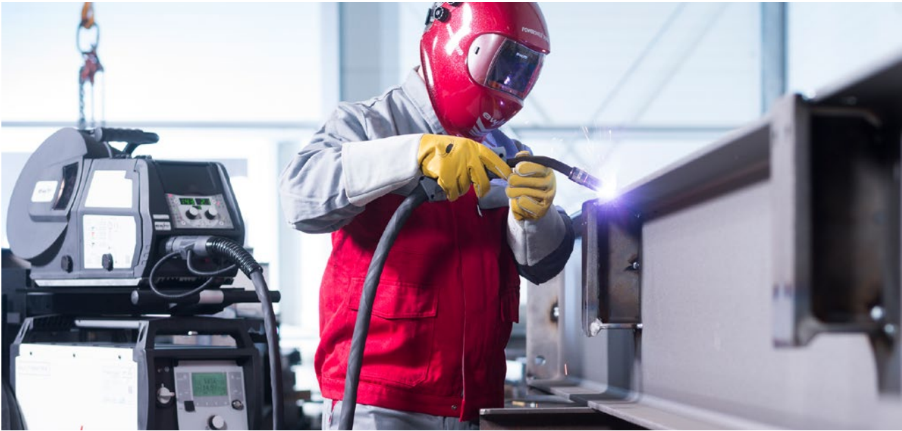
Bild 41: MAG-Schweißen im Stahlbau
