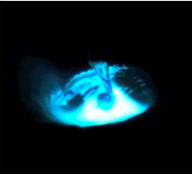
Bild 23: Tropfenübergang beim Sprühlichtbogen
