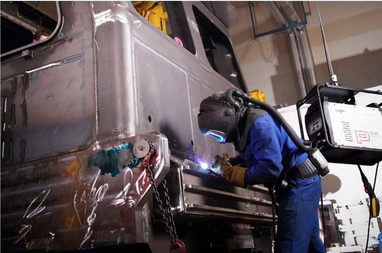
Bild 3: MAG-Schweißen im Schienenfahrzeugbau
