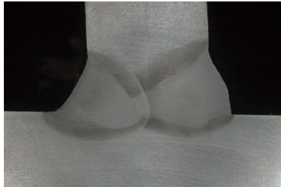
Vollanschluss beidseitig geschweißt
