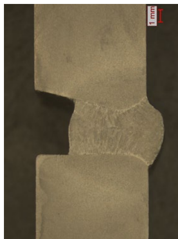
Blechdicke 10 mm, Fase einseitig 15 Grad, Luftspalt 4 mm
