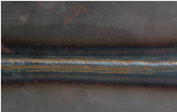
Wurzelschweißung PC mit Luftspalt, ohne Badstütze
