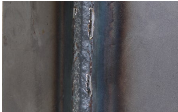
Wurzelschweißung PA mit Luftspalt, ohne Badstütze
