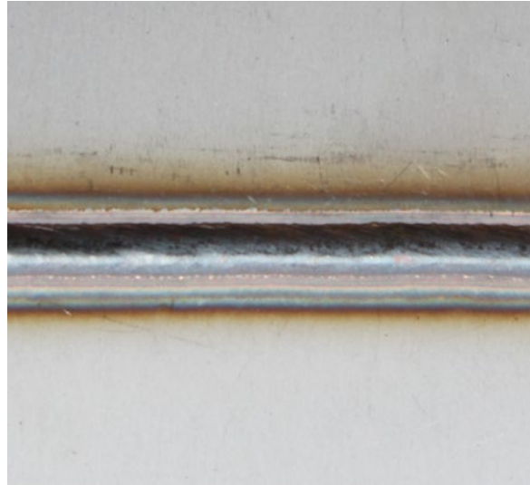
Schweißen von hochlegierten Blechen
