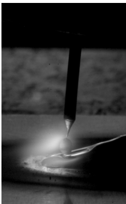
Séparation des gouttes après la phase d'impulsion
