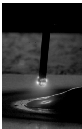
Nettoyage et préchauffage du fil en phase négative
