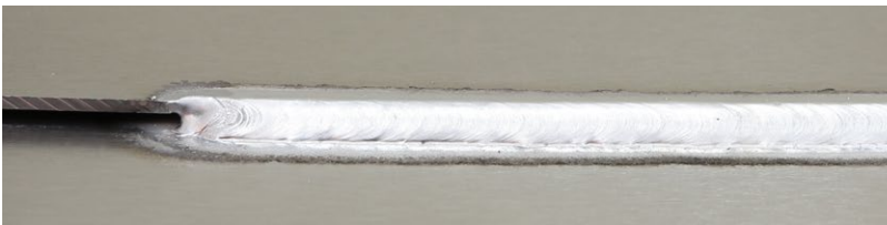
Overlaptasnaad: Plaatdikte 1,5 mm | 1,2 mm AlMg 4,5 draad | Argon 100 % 69 A | 15,4 V | Lassnelheid 70 cm/min. | Luchtspleet 1,5 mm
