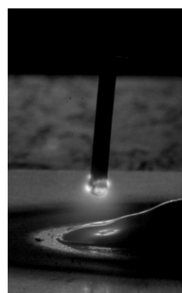
Reiniging en voorverwarming van de draad in de negatieve fase
