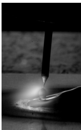
Droppupplösning efter pulsfasen
