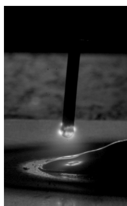
Czyszczenie i wstępne nagrzewanie drutu w fazie ujemnej
