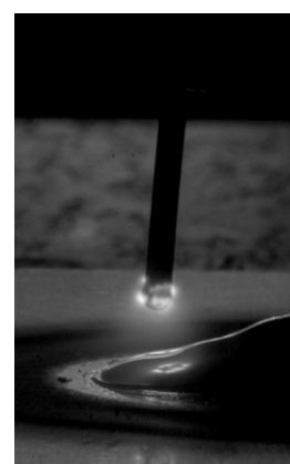
Limpeza e pré-aquecimento do fio na fase negativa
