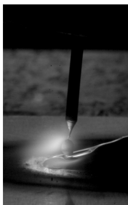
Separação de gotas após a fase de pulsação
