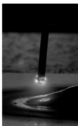
Rengjøring og forvarming av tråden i den negative fasen
