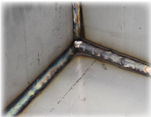
PB, PF Boîtiers en acier inoxydable (1.4501)
