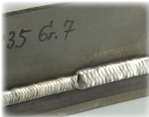
PB Passe intermédiaire et passe de finition, titane Grade 7 (3.7235)
