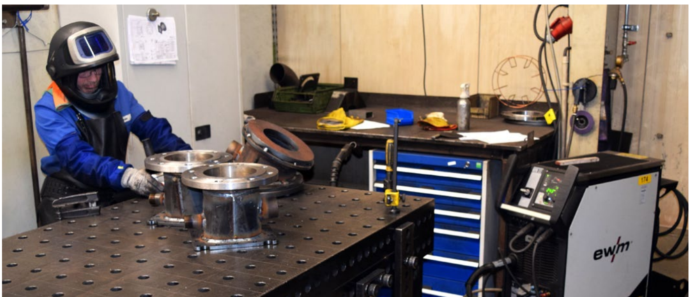
Gemeinsam mit EWM konnte Vogelsang die Nacharbeiten sowie den Verbrauch von Energie und Material erheblich senken. Dazu nahm das Unternehmen zehn MIG/MAG-XQ-Geräte in Betrieb.
