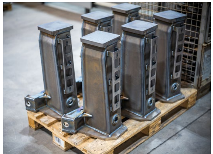
Fertig geschweißte Kabinenarme. Das manuelle Heften der Teile dauert 45 Minuten, das anschließende Schweißen mit dem Roboter inklusive vorwärmen oben und unten dauert 35 Minuten.
