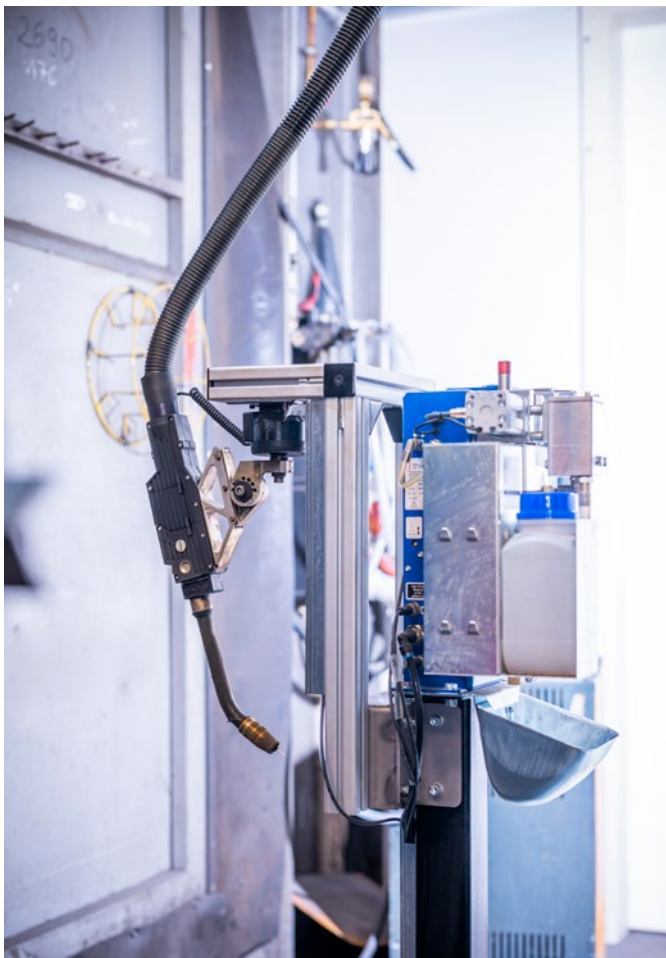
Der Schweißbrenner in seiner Parkposition. Über eine oben angeordnete pneumatische Kupplung kann der Roboter den Brenner aufnehmen. Rechts befindet sich die Brennerreinigungsstation.
