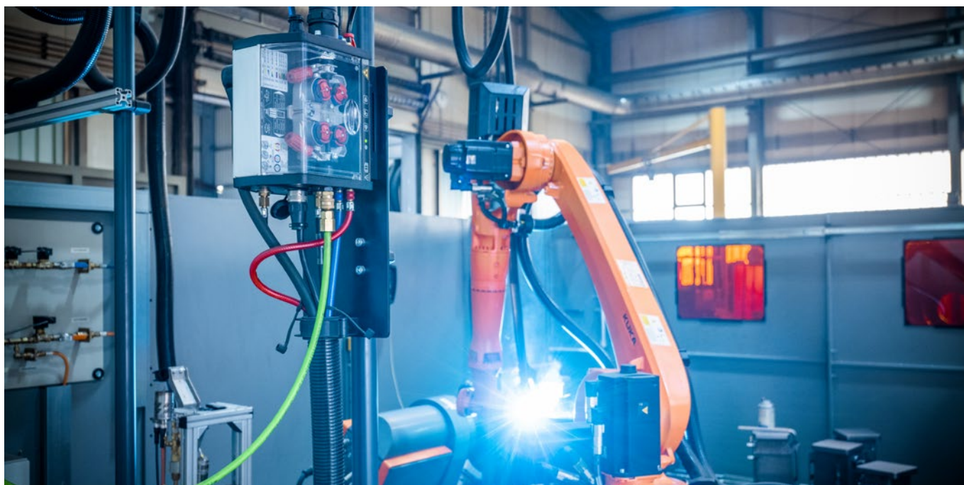
Ein separater Drahtförderer sorgt für den sicheren Transport des Zusatzwerkstoffs.
