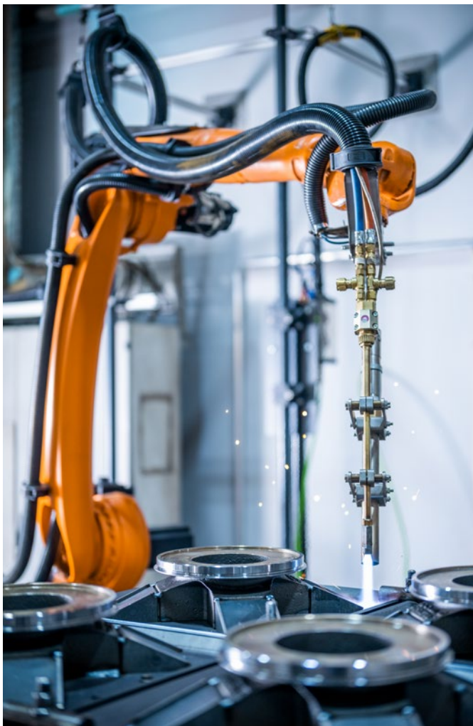
Vorwärmen der Bauteile auf dem Dreh-Kipp-Tisch mit der Traglast 1.100 kg. Parallel zum Autogenbrenner befindet sich das Schutzrohr mit dem integrierten optischen Sensor, um die Brennerflamme zu kontrollieren.
