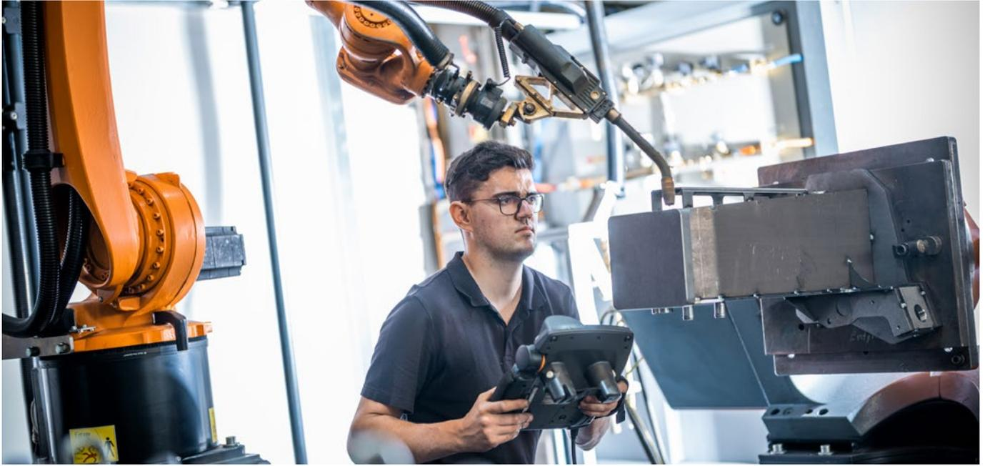
Il programmatore Lukas Kegel programma i percorsi di saldatura del componente tracciando i cordoni di saldatura con la torcia e salvando il percorso e la velocità di saldatura.
