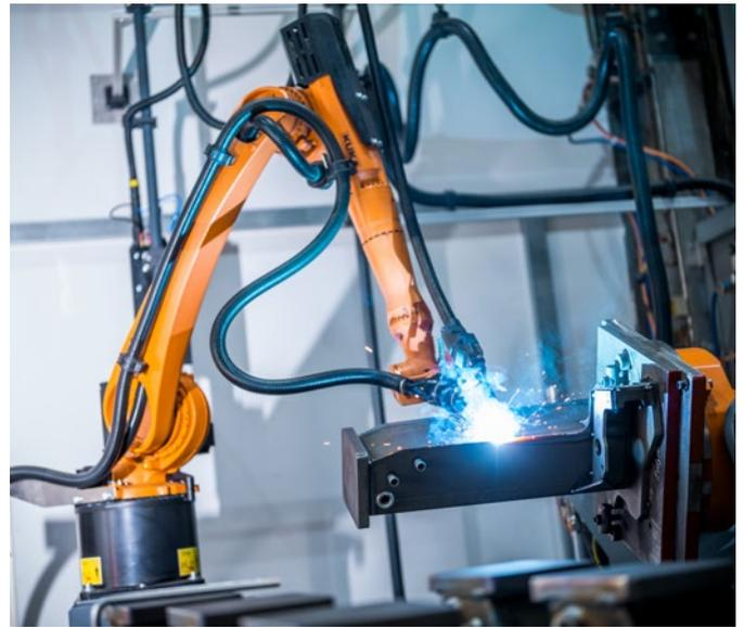
Saldatura MAG del contorno programmato del componente preriscaldato in acciaio da costruzione a grana fine. Il componente viene bloccato nel banco inclinabile-ruotabile con una portata di 500 kg.
