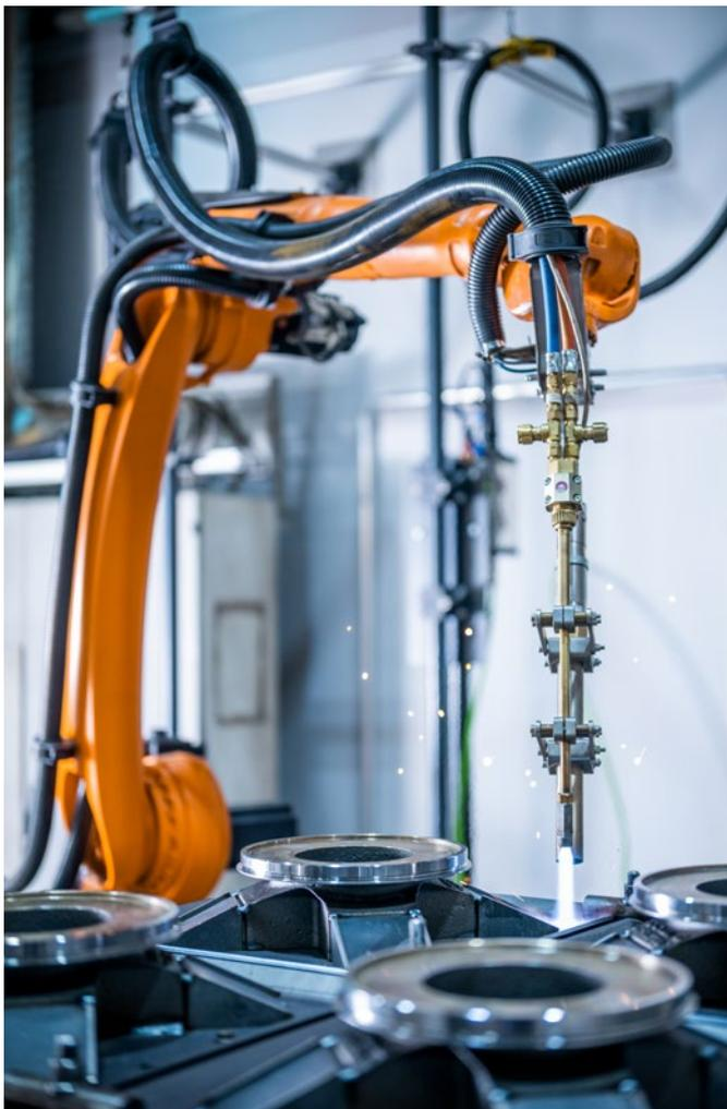
Preriscaldamento dei componenti sul banco inclinabile-ruotabile con una portata di 1100 kg. Il tubo di protezione con il sensore ottico integrato è posizionato parallelamente alla torcia ossidrica per monitorare la fiamma della torcia.
