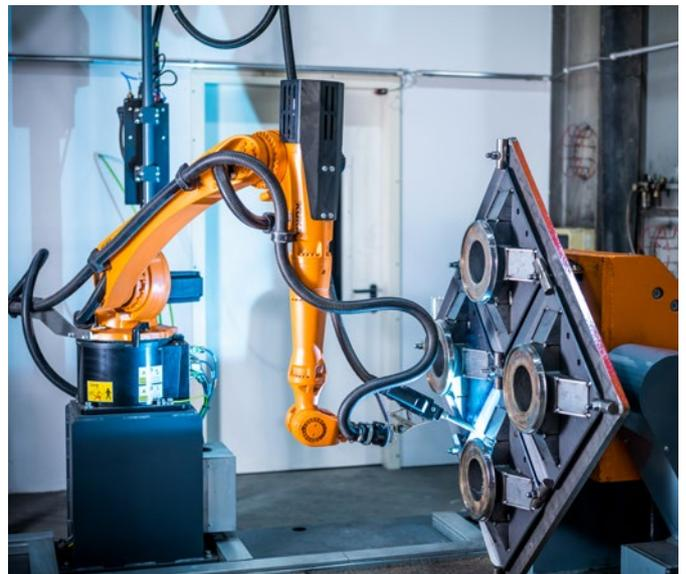
Saldatura sul banco inclinabile-ruotabile con una portata di 1100 kg. A sinistra nella parte anteriore si trova il controcuscinetto scorrevole. Sopra, la torcia ossidrica in posizione di parcheggio.
