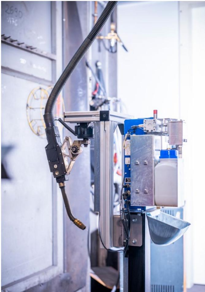
La torcia di saldatura in posizione di parcheggio. Il robot può prelevare la torcia tramite un innesto pneumatico situato nella parte superiore. A destra si trova la stazione di pulizia torce.
