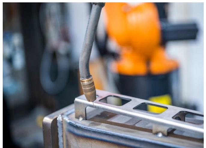
Il robot utilizza la torcia di saldatura per riconoscere la posizione esatta del componente applicato. Utilizza la punta del filo del materiale d'apporto come sonda e rileva il cortocircuito. Il programma ne ricava la posizione esatta del componente.
