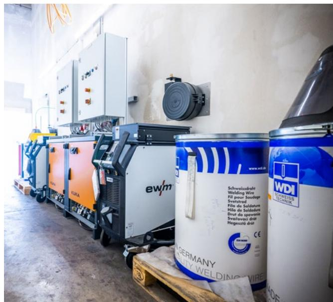
Il dispositivo di comando dell'impianto, i generatori di saldatura e il materiale d'apporto nei fusti si trovano dietro la parete posteriore della cabina di saldatura, in modo da non essere esposti allo sporco.
