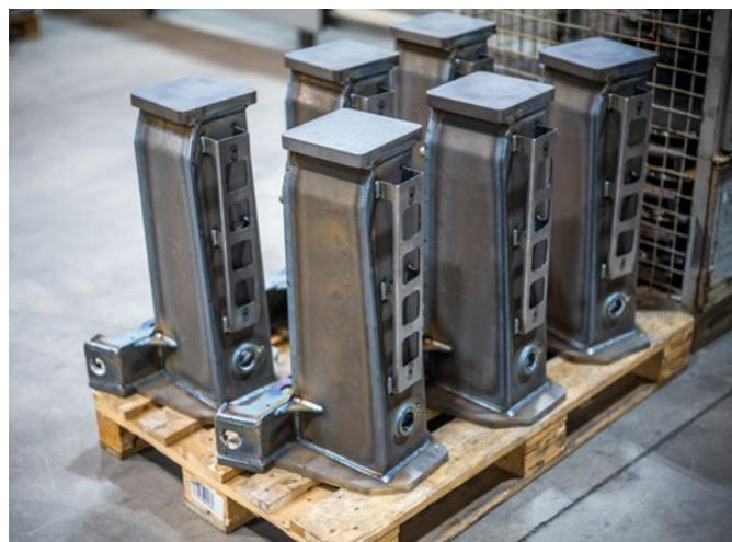
Bracci della cabina presaldati. Il fissaggio manuale dei pezzi richiede 45 minuti, mentre la successiva saldatura con il robot, compreso il preriscaldamento in alto e in basso, richiede 35 minuti.
