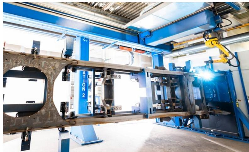
Die Drehvorrichtung hat das Chassis aufgerichtet, der Roboter schweißt wiederum in Wannelage.
