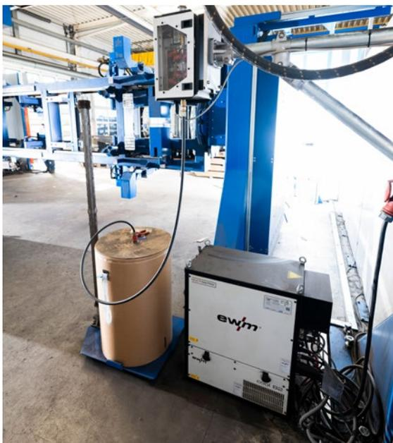
Das Schweißgerät Phoenix puls mit Fassförderung per Drahtvorschubgerät drive 4X.
