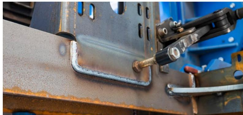
Die vom Roboter geschweißten Nähte weisen eine hohe Schweißnahtqualität und extrem wenige Schweißspritzer auf, sodass diese Nacharbeit um 30 Prozent reduziert ist – zusätzlich zur höheren Produktivität.
