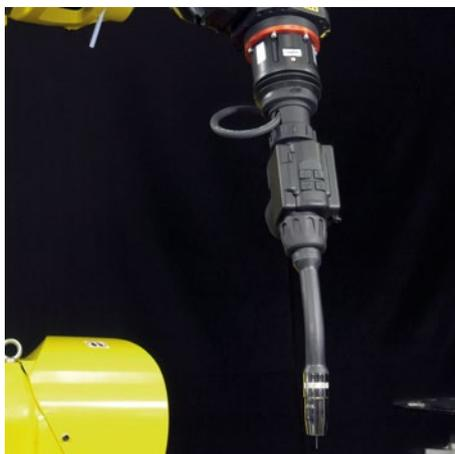
In dem speziellen coldArc<sup>+</sup> XQ - Roboterbrenner ist ein hochdynamischer Motor integriert, wodurch der Draht im hohen Frequenzbereich vor und zurück bewegt wird.
