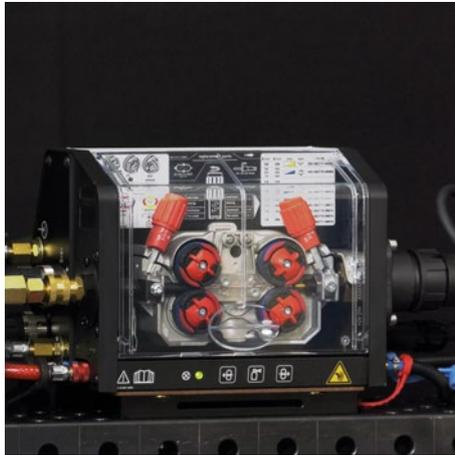
Das M Drive 4 Rob 5-Drahtvorschubgerät sorgt für eine kontinuierliche Drahtversorgung über einen abgestimmten Mittelwert.
