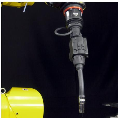
Dans la torche de soudage robot spéciale coldArc<sup>+</sup> XQ, un moteur hautement dynamique est intégré, ce qui permet au fil de se déplacer d'avant en arrière dans la plage de fréquence élevée.
