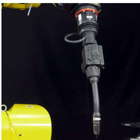
Nella torcia di saldatura robot speciale coldArc<sup>+</sup> XQ è integrato un motore altamente dinamico, per cui il filo viene mosso in avanti e indietro in un campo di regolazione della frequenza.
