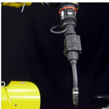
En la antorcha automática coldArc<sup>+</sup> XQ especial hay integrado un motor altamente dinámico con el que el hilo se desplaza adelante y atrás en un rango de alta frecuencia.
