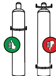
**Pour obtenir des résultats optimaux en matière de soudage, l'alimentation en gaz de protection doit pouvoir s'effectuer sans entrave depuis la bouteille de gaz de protection jusqu'à la torche de soudage. En outre, toute obturation de cette alimentation peut entraîner la destruction de la torche !**
