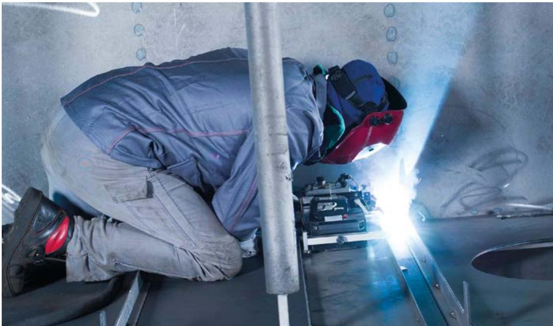
Grazie all'impiego di un trattore di saldatura su pista e alla continuità e uniformità di lavorazione che ne derivano, Mesa ha potuto migliorare la qualità. I tempi di lavorazione e produzione sono stati dimezzati.
