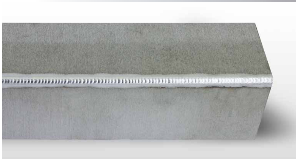
Специальная сварка переменным током – внешний угловой шов, 3 мм
