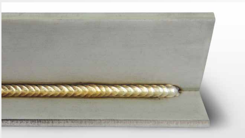
Импульсная сварка TIG – угловые швы таврового соединения в положении РВ
