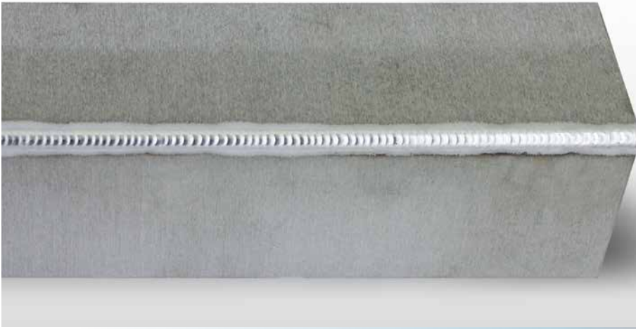
AC özel – Dıştan dışa köşe kaynağı, 3 mm
