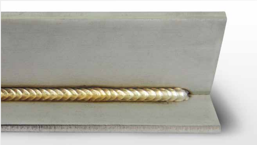
WIG pulsování – koutový svar, poloha PB
