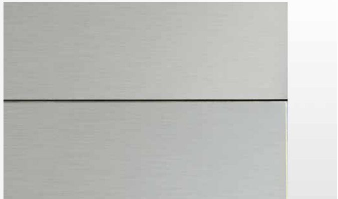
spotmatic – geen aanloopverkleuring (0,8 mm plaat achterzijde)
