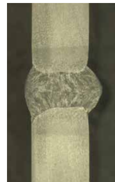
Tloušťka plechu 5 mm Vzduchová mezera 3 mm
