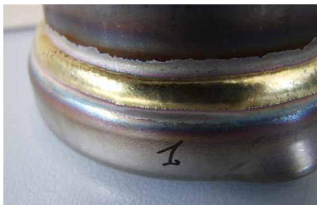
Lödning av höglegerade (CrNi) plåtar
