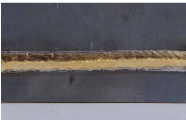
Lödning av högfasta plåtar, t.ex. Usibor ®
