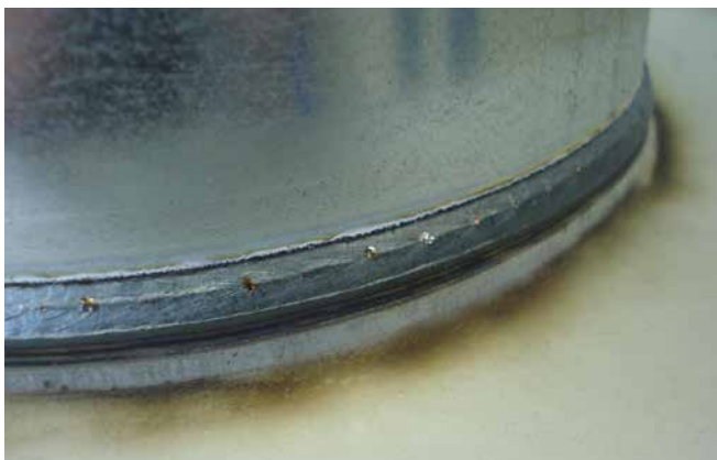
Saldatura di lamiere zincate
