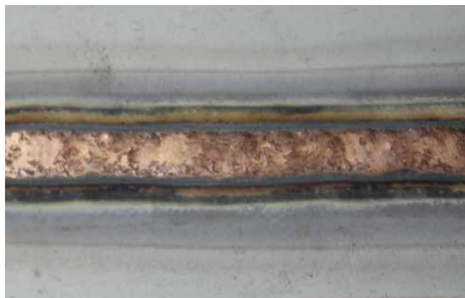
Brasatura di lamiere zincate
