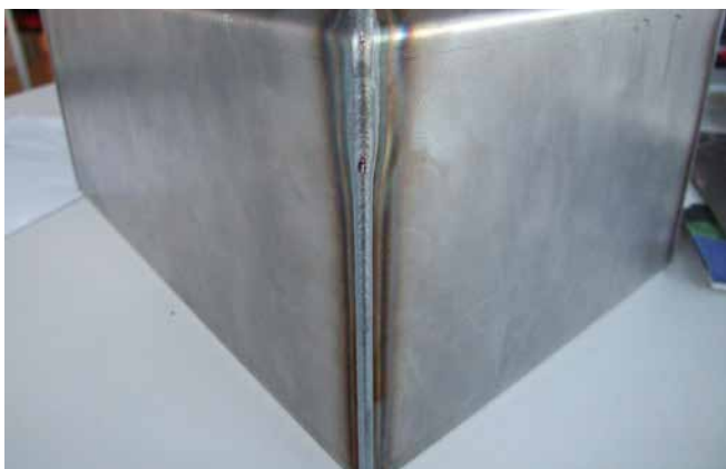
Saldatura di lamiere non legate
