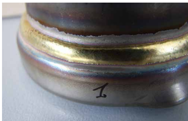
Brasatura di lamiere fortemente legate (CrNi)
