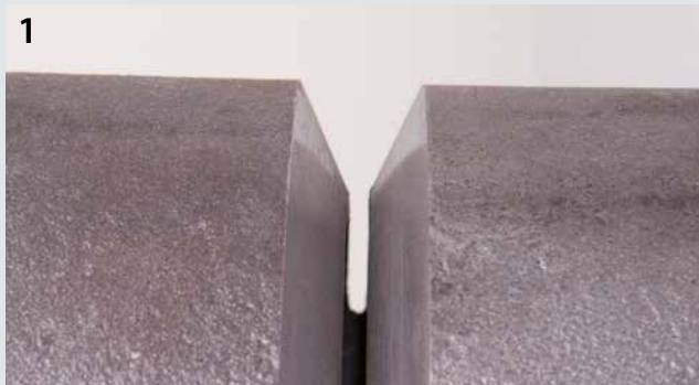
Preparazione del cordone di una saldatura di prima passata su tubo, angolo di apertura della saldatura di 60° con 3 mm di passata
