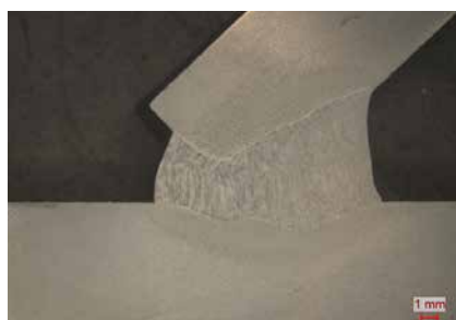
Godstykkelser kropplade 10 mm, sømåbningsvinkel 35^\circ
