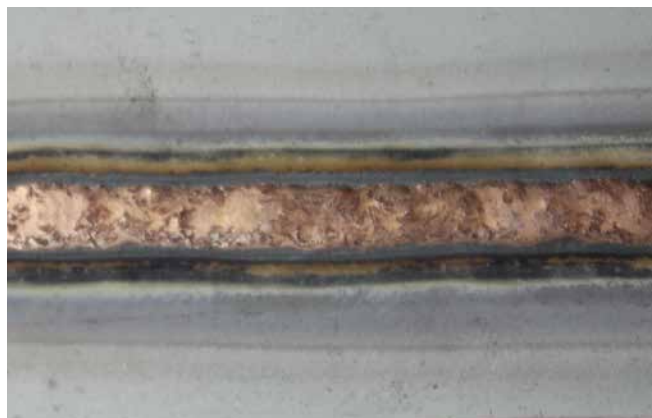
Sinkittyjen levyjen juotto
