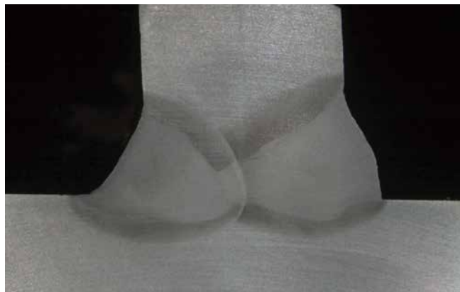
PB Molemminpuolinen hitsattu täystunkeuma
