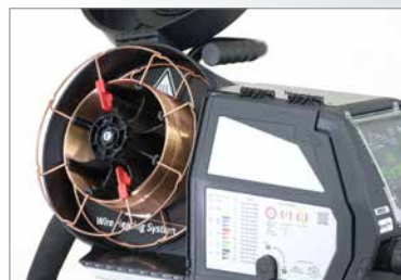
WRS – jäljellä olevan lankamäärän anturi
