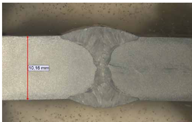
PA Molemminpuolinen hitsattu täystunkeuma
