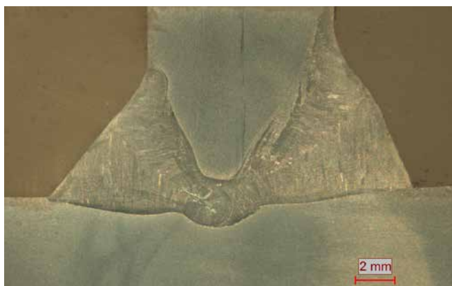
PB Molemminpuolinen hitsattu täystunkeuma
