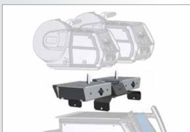
Két huzalelőtoló készülék felfogása
