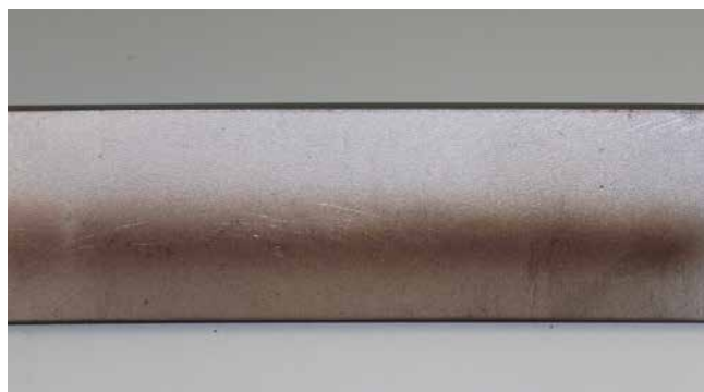
Hátoldal: Csekély hőbevitel a forceArc puls® esetén, a felület kisebb oxidációja
