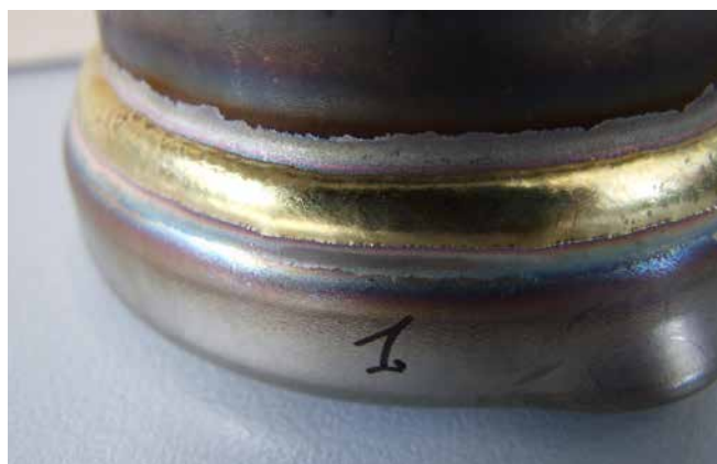
Erősen ötvözött (CrNi) lemezek keményforrasztása
