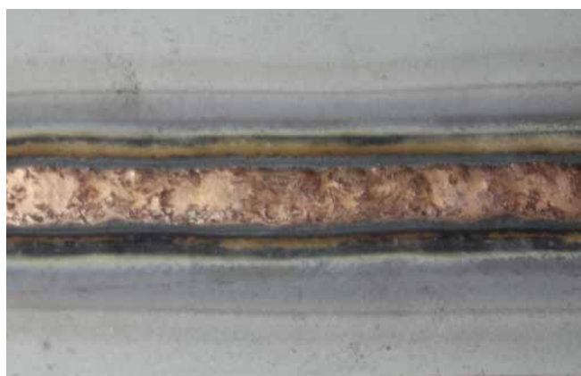
Horganyzott lemezek keményforrasztása
