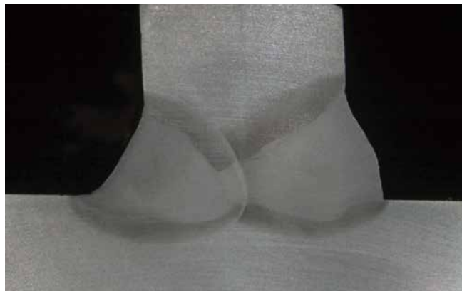
PB Teljes kapcsolat, kétoldalt hegesztett
