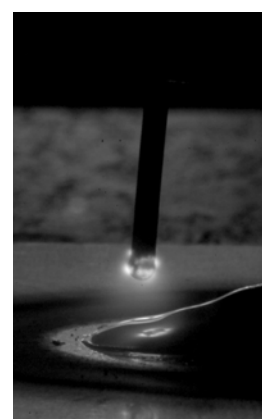
Очистка и подогрев проволоки в отрицательной фазе
