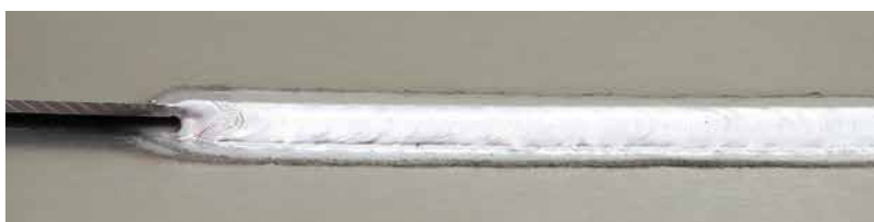
Шов внахлестку: лист толщиной 1,5 мм | 1,2 мм AlMg 4,5 проволока | Аргон 100 % | 69 А | 15,4 В | скорость сварки 70 см/мин. | воздушный зазор 1,5 мм
