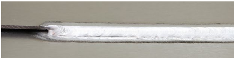
Overlappasnaad: Plaatdikte 1,5 mm | 1,2 mm AlMg 4,5 draad | Argon 100 % | 69 A | 15,4 V | lassnelheid 70 cm/min. | Luchtspleet 1,5 mm
