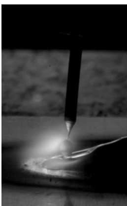
Séparation des gouttes après la phase d'impulsion
