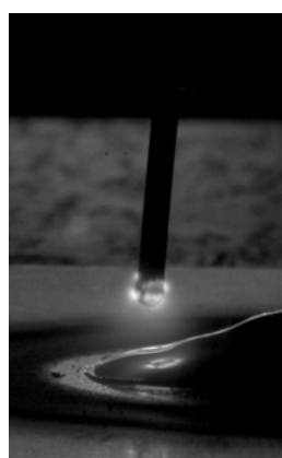
Nettoyage et préchauffage du fil en phase négative
