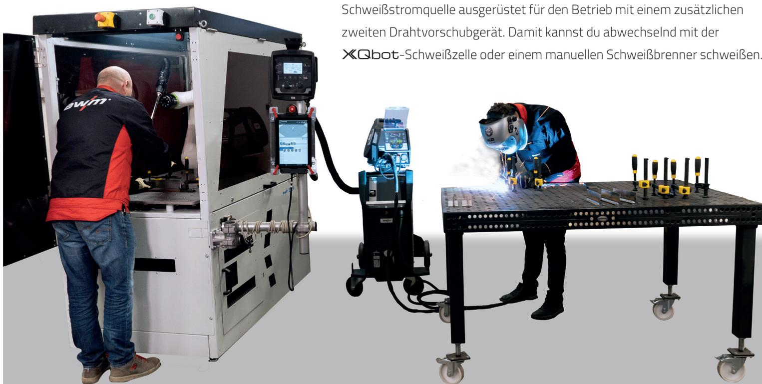
Schweißstromquelle ausgerüstet für den Betrieb mit einem zusätzlichen zweiten Drahtvorschubgerät. Damit kannst du abwechselnd mit der XQbot-Schweißzelle oder einem manuellen Schweißbrenner schweißen.
