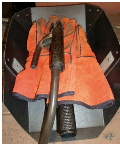
Abb. 4-2 Ohne Elektrodenrest isoliert abgelegter Stabelektrodenhalter
