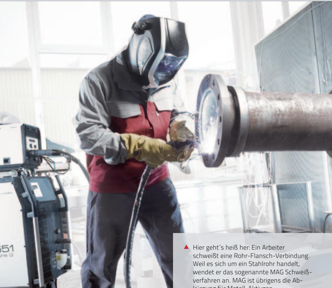
▲ Hier geht's heiß her: Ein Arbeiter schweißt eine Rohr-Flansch-Verbindung. Weil es sich um ein Stahlrohr handelt, wendet er das sogenannte MAG Schweißverfahren an. MAG ist übrigens die Abkürzung für Metall-Aktivgas.
