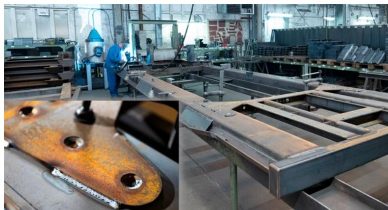
El innovador proceso de soldadura forceArc puls se utiliza en todos los ámbitos de la construcción metálica para soldar acero negro sin tratar. La seguridad del proceso es elevada y la costura perfecta sin casi proyecciones.
