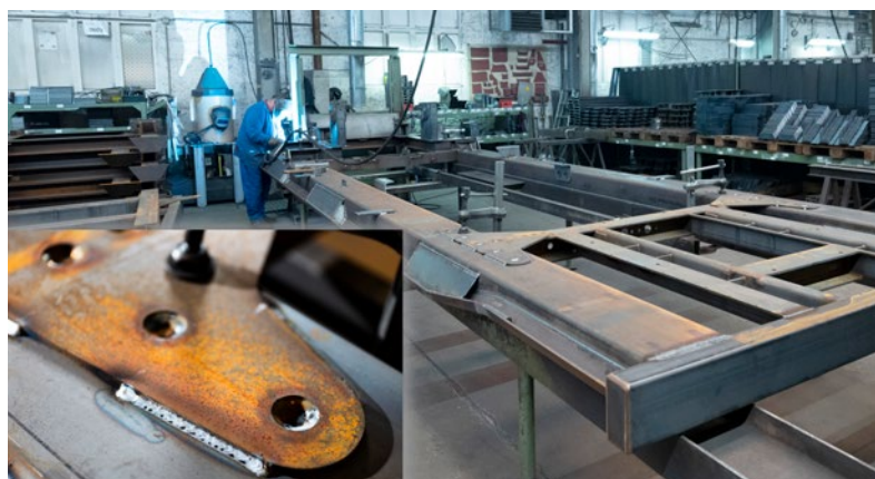
Het innovatieve lasproces forceArc puls wordt in alle afdelingen van de staalbouw voor het lassen van onbehandeld zwart staal gebruikt. De procesveiligheid is hoog en de nagenoeg spatvrije lasnaden perfect.
