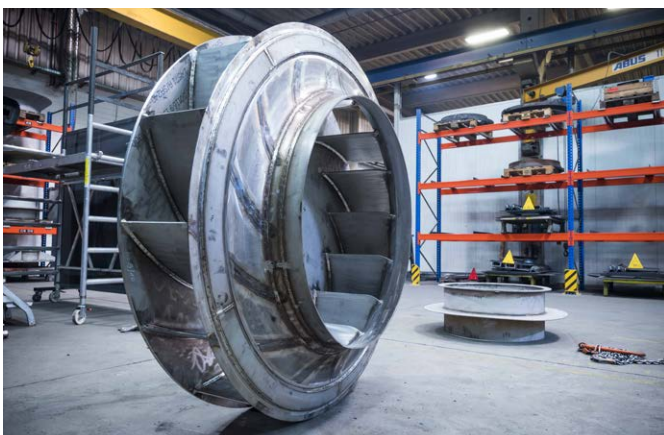
Ein geschweißtes Lüfterrad mit 3,5 Meter Durchmesser. Inclusive der Versteifungsringe befinden sich hier über 60 Meter Schweißnähte in dem Bauteil.
