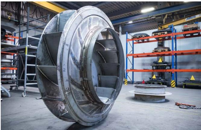
Hélice de ventilador soldada de 3,5 metros de diámetro. Incluidos los anillos de refuerzo, en este componente hay costuras de soldadura de más de 60 metros.
