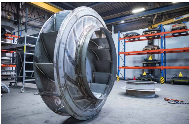
Een gelast ventilatorwiel met een diameter van 3,5 meter. Inclusief de verstevigingsringen bevinden zich in het bouwdeel bij lasnaden langer dan 60 meter.
