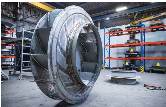
Spawany wirnik wentylatora o średnicy 3,5 metra. Łącznie z pierścieniami usztywniającymi w komponencie znajduje się ponad 60 metrów spoin.
