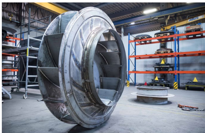
Svařované oběžné kolo ventilátoru o průměru 3,5 metru. Včetně výztužných kroužků se na této součásti nachází více než 60 metrů svarů.
