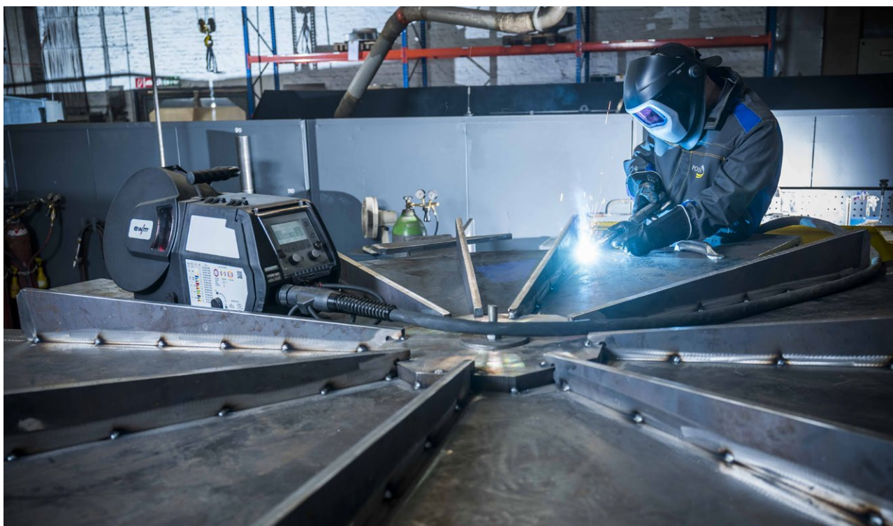
POLLRICH konstruuje a vyrábí také nářadí pro svou vlastní výrobu. Zde se příčkami vyztužuje lícní deska pro přitlačné zařízení.
