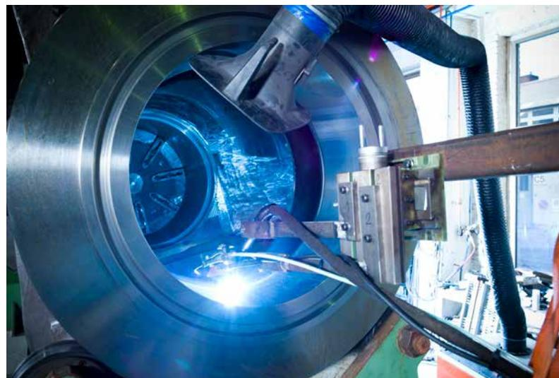
Der Schweißprozess ist abgeschlossen. Die Aufschweißung ist etwa einen Millimeter höher ausgelegt als das spätere Endmaß der Auftragsschicht. Nun wird die Schicht noch überdreht, dann ist die Fläche endbearbeitet.
