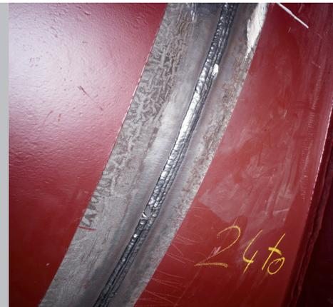
/ Perfektes MAG-Schweißen in einem Arbeitsgang – der programmgesteuerte energiereduzierte pipeSolution®-Prozess sorgt in jeder Schweißposition für die gewünschte Schmelzbad-Viskosität
