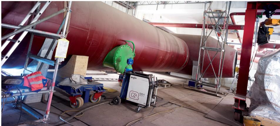
/ Kühlwasser-Rohrleitungen mit Durchmessern bis zu 3.400 Millimetern – Segment passgenau verschweißt – erstmals mit vom TÜV Hessen zertifiziertem MAG-Verfahren
