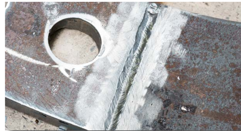
Der von 60° auf 40° reduzierte Öffnungswinkel erfordert beim forceArc-Schweißen weniger Schweißraupen. Das reduziert die Schweißzeit und spart Kosten.
