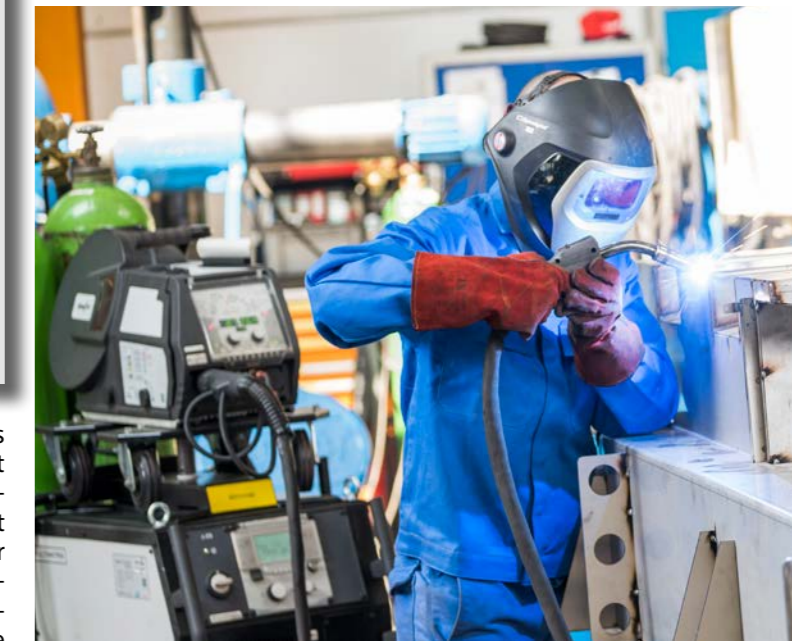
Nahezu spritzerfreies Schweißen der Eck-, Kehl- und Stumpfnahten an einem Düsenkasten von einem Anlassofen. Das wärmereduzierte coldArc-Verfahren minimiert den Verzug beim Fügen der 2 Millimeter dicken Edelstahlbleche.
