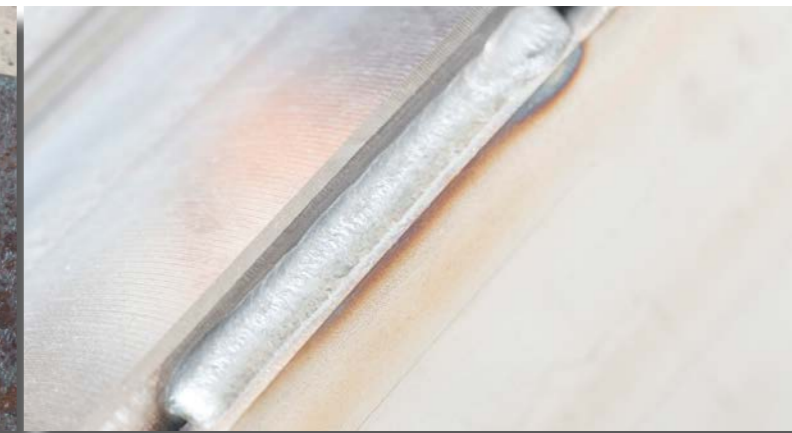
Die MAG-geschweißte Kehlnaht in PB ist nahezu spritzerfrei.
