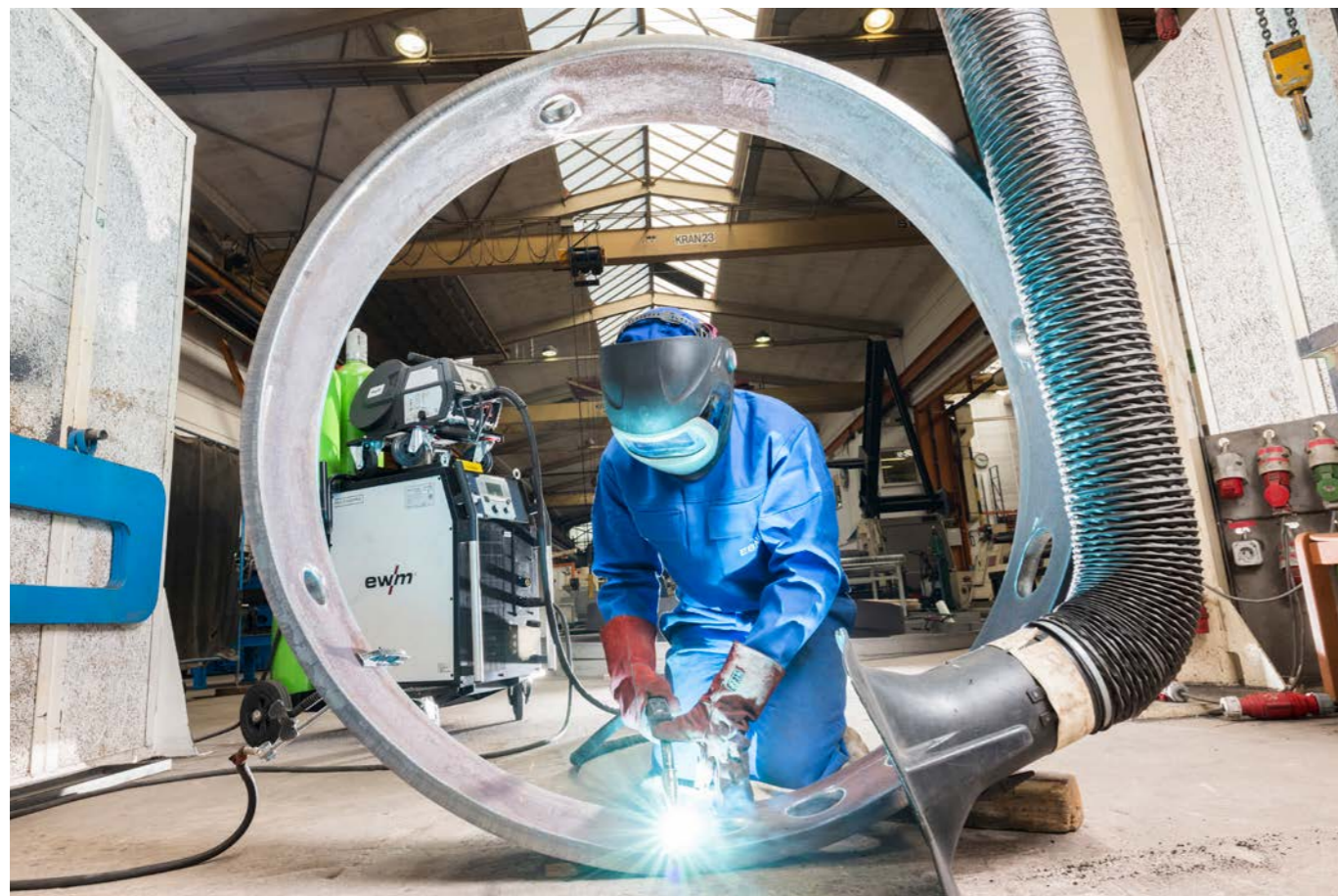
Schweißen der X-Naht eines Stahlrings mit forceArc
