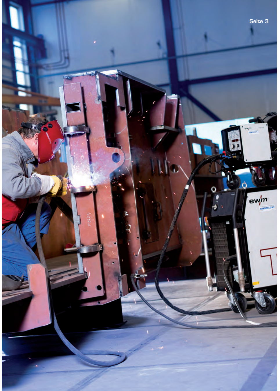
/ Die Multiprozess-Stromquelle Taurus 451 beherrscht auch den Fügeprozess forceArc®
