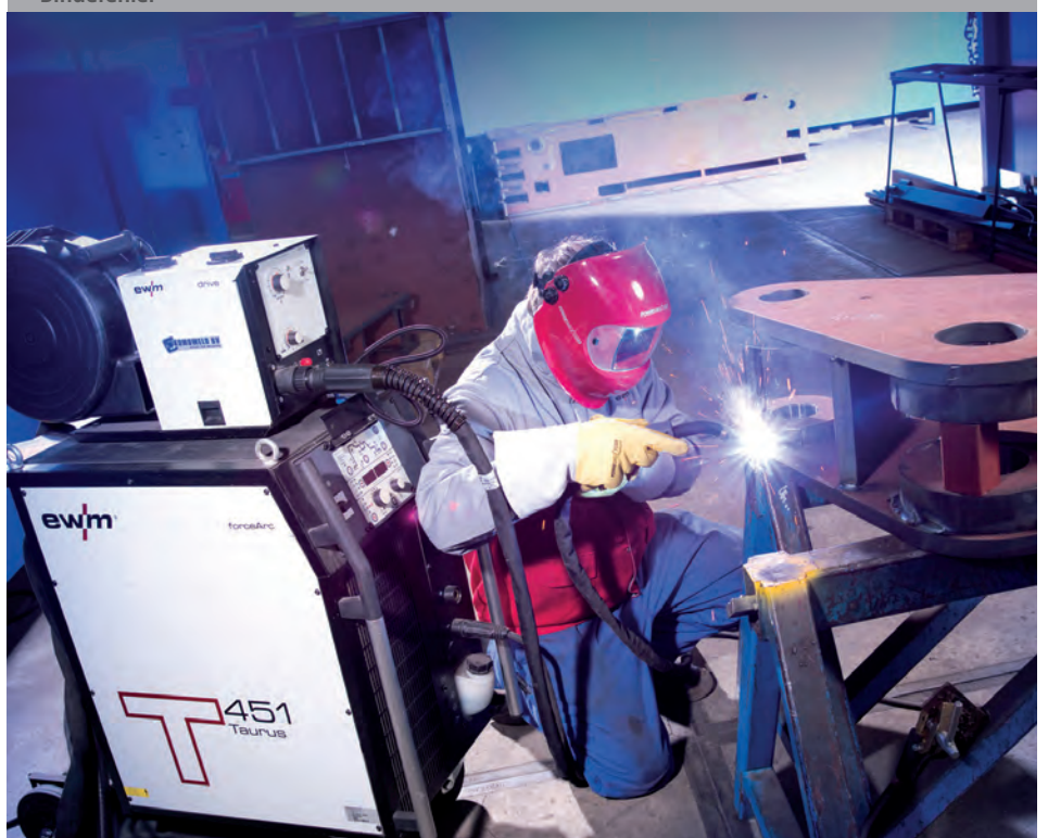
/ Massive Hydraulikkonstruktion für Ballenpresse: Innovativer Fügeprozess – druckvoller Lichtbogen, guter Einbrand und gute Flankenbenetzung, schmale Wärmeeinflusszone, Sicherheit gegen Bindefehler
