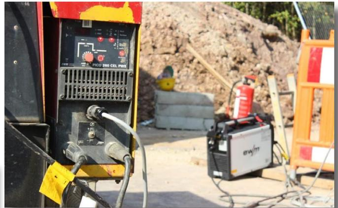
тельства трубопроводов даже при наличии сильных магнитных полей. Требующиеся для этого компоненты являются удобными, компактными и подходящими для стройплощадок. Очень простая эксплуатация, при помощи дистанционного регулятора источник тока можно располагать даже за пределами строительного котлована.
